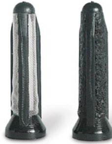
E1F'nin ön filtresi: sol yeni, sağ tıkanmış
