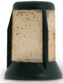
E3T'nin ön filtresi – pas nedeniyle tıkanmış
